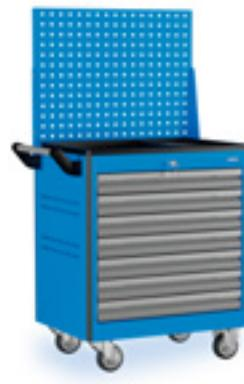
Перфоэкран предназначен для размещения навесных элементов. На экране выполнена квадратная перфорация 12x12 мм с шагом 38 мм для установки крючков, держателей ключей, отверток сверл, габариты экрана 500x673x20.
