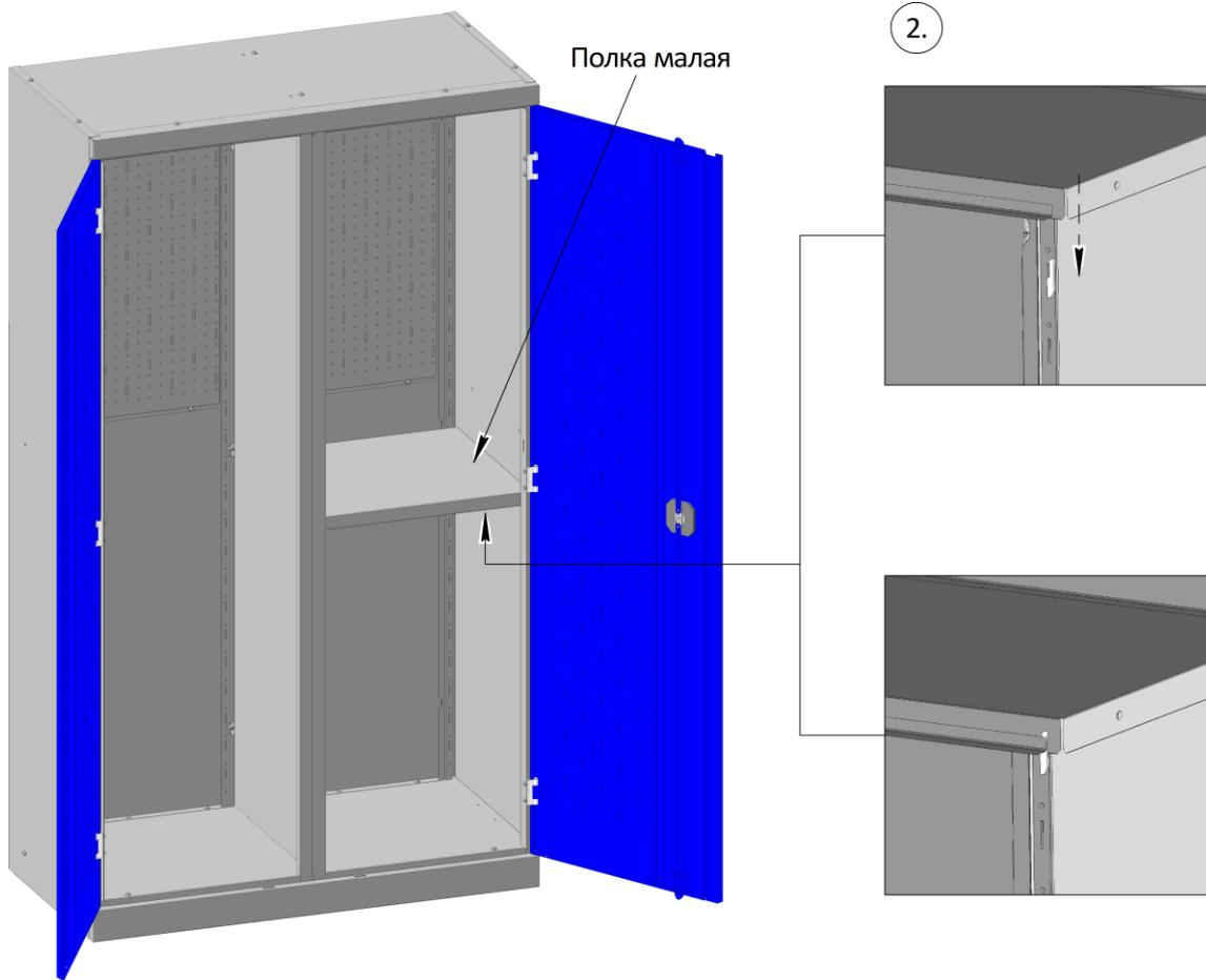
1. Определите, в каком месте будет установлена полка (полки). Возьмите из комплекта 4 скобы полки, установите их в вертикальные пазы, которые расположены в профильных частях углов шкафа (перегородки), установка скобы показана на схеме. В нижней части скобы имеется малый паз, смещённый к краю, ориентируйте скобу так, чтобы паз был направлен внутрь профильной части.
