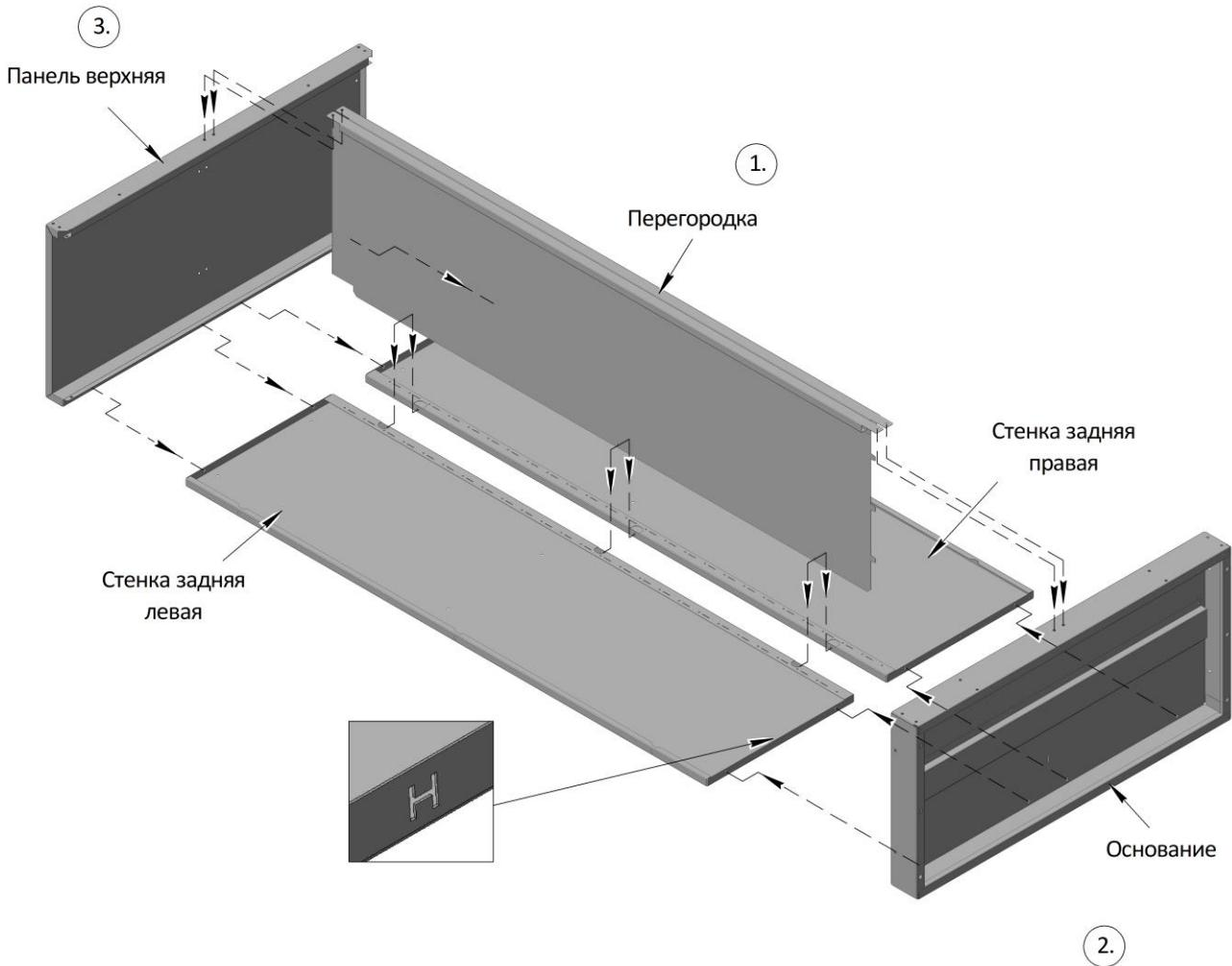
1. Разместите левую и правую задние стенки профильными частями к середине, как показано на рисунке, на торцевой стороне каждой стенки имеется буква «Н» обозначающая нижнюю часть. Между ними установите перегородку, так чтобы 3 язычка были направлены в нижнюю часть стенок, и соедините элементы через совпадающие отверстия (обозначены пунктиром) при помощи 3-х винтов M6x13мм. шайб и гаек M6, но не затягивая их.
